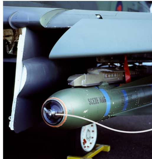
IR detector: (HgCd)Te
